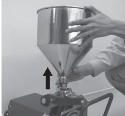
①ホッパー、ホース、チューブバンド、カップリングを取り外し、チューブのみの状態にする
